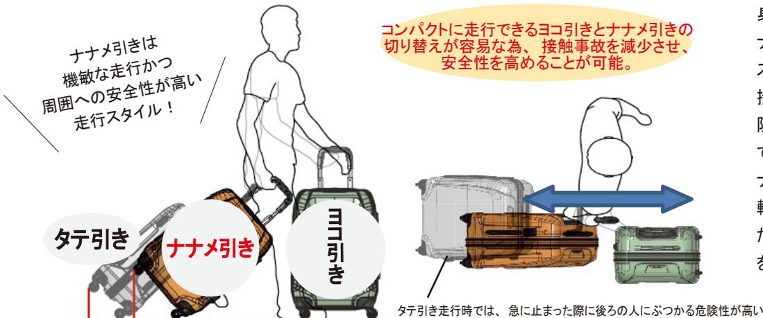
身体の側面で2輪走行をするナナメ引きは、使用する人とスーツケースの距離が短く、接触事故などのトラブルを最小限にすることができます。加えて力強く機敏な走行が可能。ナナメ引きした際のふらつきを軽減する為、底部に重心をもたせた安定性の高いフォルムを採用しています。
